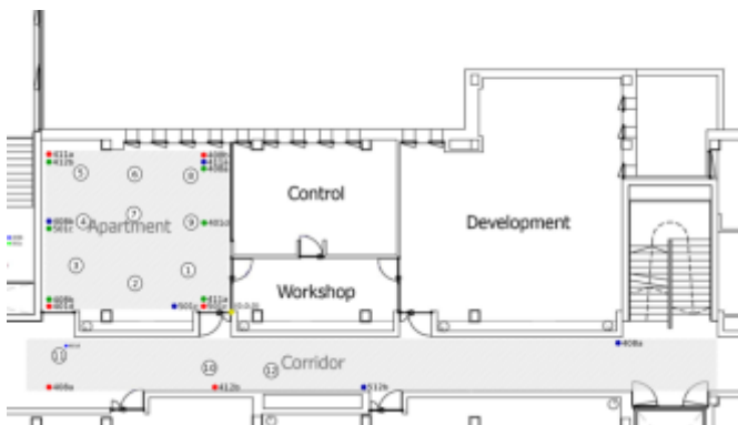
Figura 3: Diferentes distribuciones (colores) de antenas del RTLS-KIO
