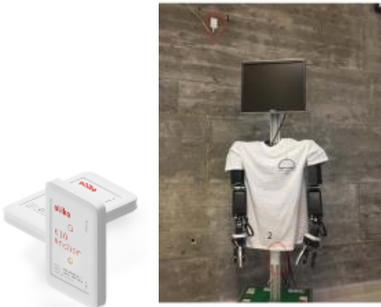
Figura 2: Izquierda: Balizas del sistema de localización KIO-RTLS y derecha robot Karen equipado con el sistema
