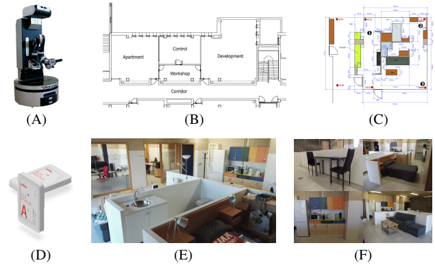
Figura 4: Elementos utilizados para la recopilación de datos. A: Robot Orbi-One. B: plano de Leon@Home Testbed. C: plano del apartamento. Los puntos rojos muestran la ubicación de las balizas del dispositivo KIO. Los puntos negros numerados muestran la posición de Orbi-One durante la recolección de datos. D: balizas del dispositivo KIO E: vista general del apartamento. F: Mobiliario del apartamento.
