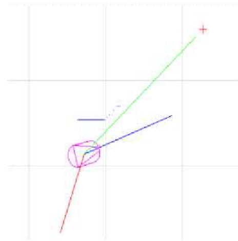
Fig. 9. Cálculo de fuerzas virtuales para la navegación local
